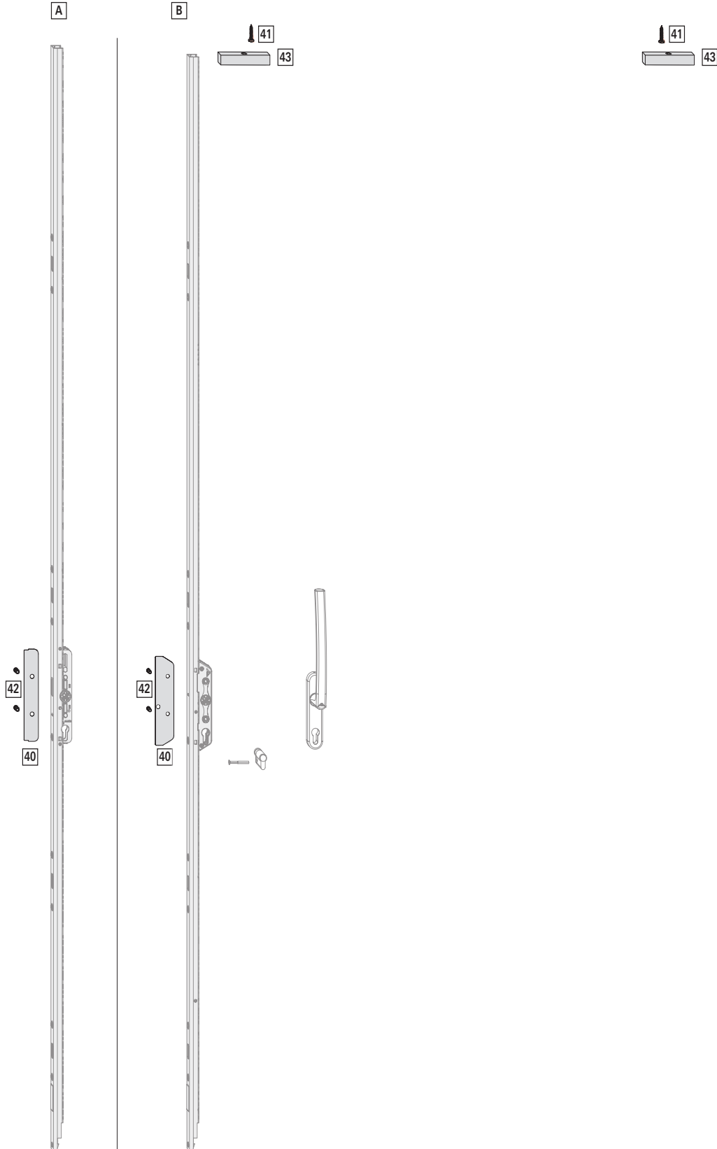
Şek. 4.11: Şekilde gösterilen: Diyagram A; sol model; KY 2400 mm; Slim [A] 200 kg ve Standart [B] KA 300 / 400 kg; kilitlenebilen kollar
